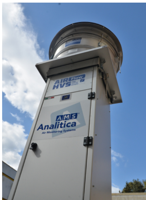
Il campionatore ad alto volume utilizzato per raccogliere il particolato atmosferico nei pressi delle scuole coinvolte nello studio MAPEC_LIFE
